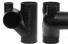
Parte No. NH 457 Tee Para Inodoro Con Ventilación Superior de 2" (Mano Izquierda o Mano Derecha; Diseñada para usarse por debajo del nivel del suelo; la Conexión no requiere deflector.)
