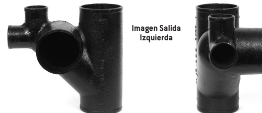
Parte No. NH 463 Cruz Para Inodoro Con Ventilación Superior de 2" (Diseñada para usarse por debajo del nivel del suelo; la Conexión tiene un deflector.)
